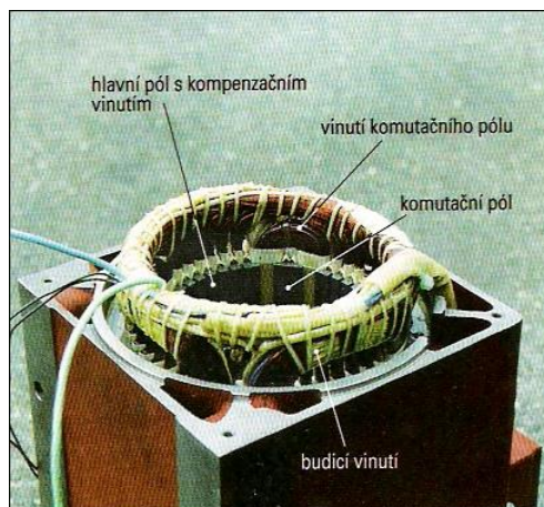
Obr. 62 Generátor s komutačními póly a kompenzačním vinutím
